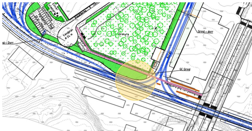
Figur 10. För gång- och cykelpassagen över spåren (där gång- och cykelbanan i lila korsar blåa spår) är det viktigt att ledande och förhindrande åtgärder finns för att leda korsande trafikanter på ett trafiksäkert sätt. Passagen måste även kunna nyttjas av räddningstjänst. I figuren illustreras det med orangea streck var ledande eller förhindrande hinder bör placeras och i gul cirkel var sikten för spårvagnsförare mellan uppställningshall och tvätt/städhall kan vara extra begränsad.
