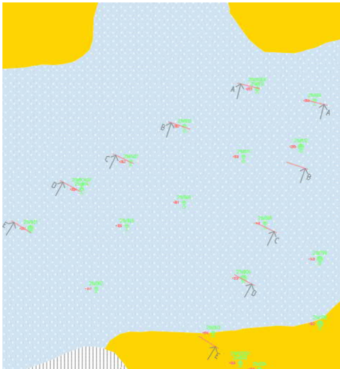
Figur 2. SGU's jordartskarta med utförda sonderingar. Blå färg=morän, gul färg=lera och skrafferade områden=fyllning.
