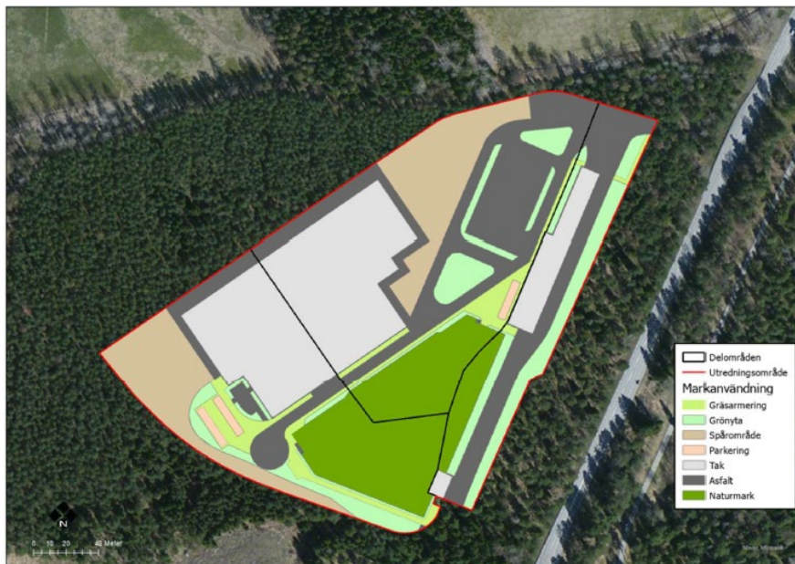
Figur 20 Föreslagna ytor inom verksamhetsområdet för spårvagnsdepå med olika föroreningsgrad av dagvatten och möjlighet till infiltration.
