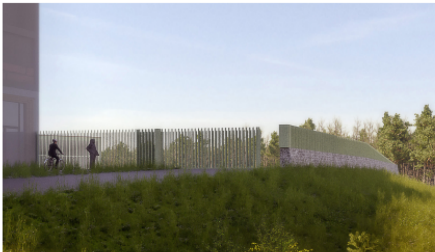
Figur 7 Illustration av exempel på mur i kombination med staket - i övergången mellan höjdskillnader innanför och utanför depåområdet (White, & Rundqvist)
