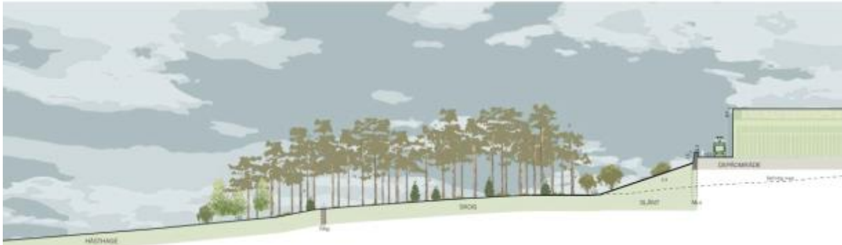
Figur 24. Sektion från väster med principer för hantering av höjdskillnad med planterad slänt i kombination med mur (&Rundquist och White Arkitekter).
