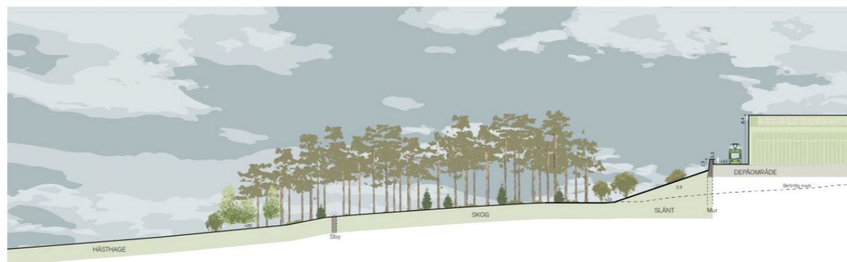
Sektion från väster med princip upptagning av höjdskillnad med planterad slänt i kombination med mur (©Rundquist och White Arkitekter).
