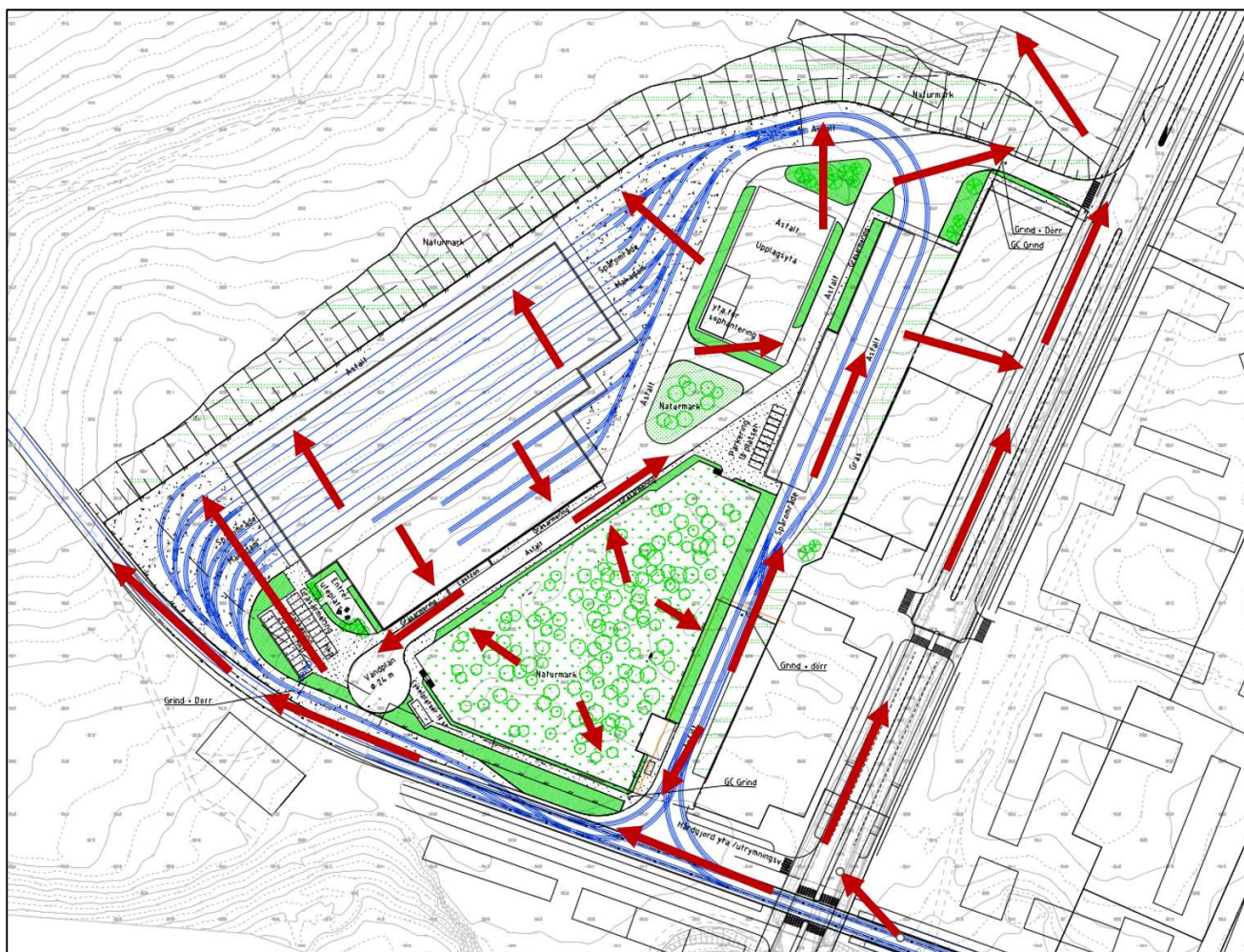
Figur 6.3: Skyfallshantering för planområdet. Vattnet ska obehindrat kunna rinna enligt de röda pilarna vid extrema regn. Området är platt för att möjliggöra för spårvägen och därför kan en dämning på några decimeter ske på ytan. Den stödmur som anläggs runt depå behöver ha öppningar för att vatten ska kunna flöda ut.
