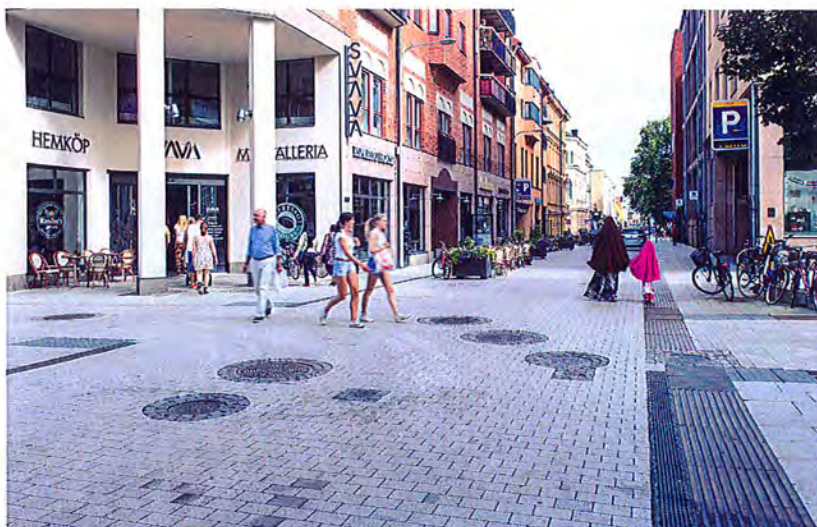
Längs Dragarbrunnsgatan används ljusa betongplattor av olika typ och storlekar.
