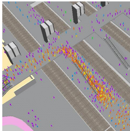
Figur 27. Ögonblicksbilder från simulering av alternativa placeringar av lyftpaket.
