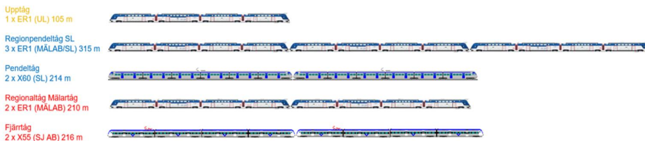
Figur 4. Fordonstyper och tåglängder. Källa: Trafikverket, Fyra spår Uppsala, Söder Bergsbrunna-Uppsala C, Informationshandling, Förgranskning. Gestaltning. PM Gångflöden Uppsala C, 2022-04-29
