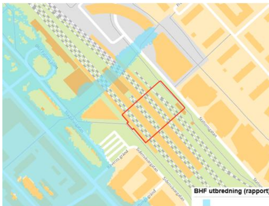
Figur 19. Område som förväntas att översvämmas vid ett beräknat högsta flöde redovisas i ljusblått. Planområdet markerat med röd linje.
