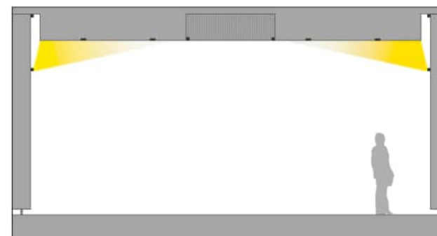
Figur 26. Principskiss för lättad av undertaket. Armaturer monterade på vartannat pelarpar lyser upp undertaket av trä. Detta balanserar rummet och skapar en harmoni med det nedåtriktade ljuset på golvet interiört och mot släpljuset från en exteriör synvinkel. Ställer krav på att det inte slarvas med installationer som syns i undertaket.
