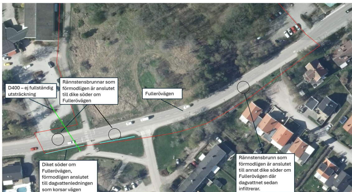
Figur 12. Befintliga rännstensbrunnar och förmodad avledning av dagvatten enligt information från Uppsala Vatten (2025-03-21). Svarta cirklar visar ungefärligt läge för befintliga rännstensbrunnar enligt analys i Google Maps.
