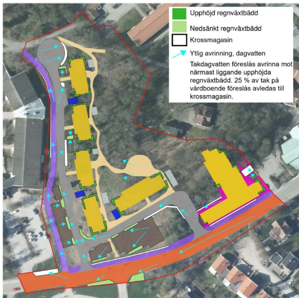
Figur 17 Föreslagna dagvattenåtgärder markerade på flygfoto över planområdet. Regnväxtbäddar kan placeras intill fasader, parkeringar och längs Fullerövägen.
