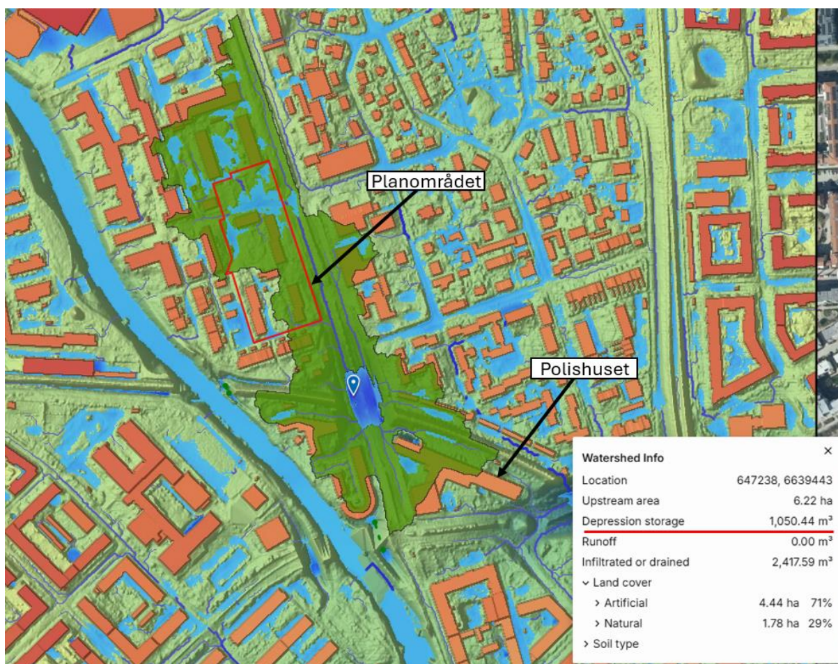
Figur 7-4: Lågpunkten med ackumulerad vattenvolym vid polishuset för ett 100-årsregn före exploatering.
