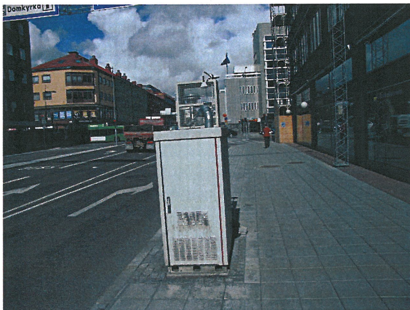
Figur 1 Mätskåp för \text{NO}_x och \text{PM}_{10} på Kungsgatan i Uppsala
