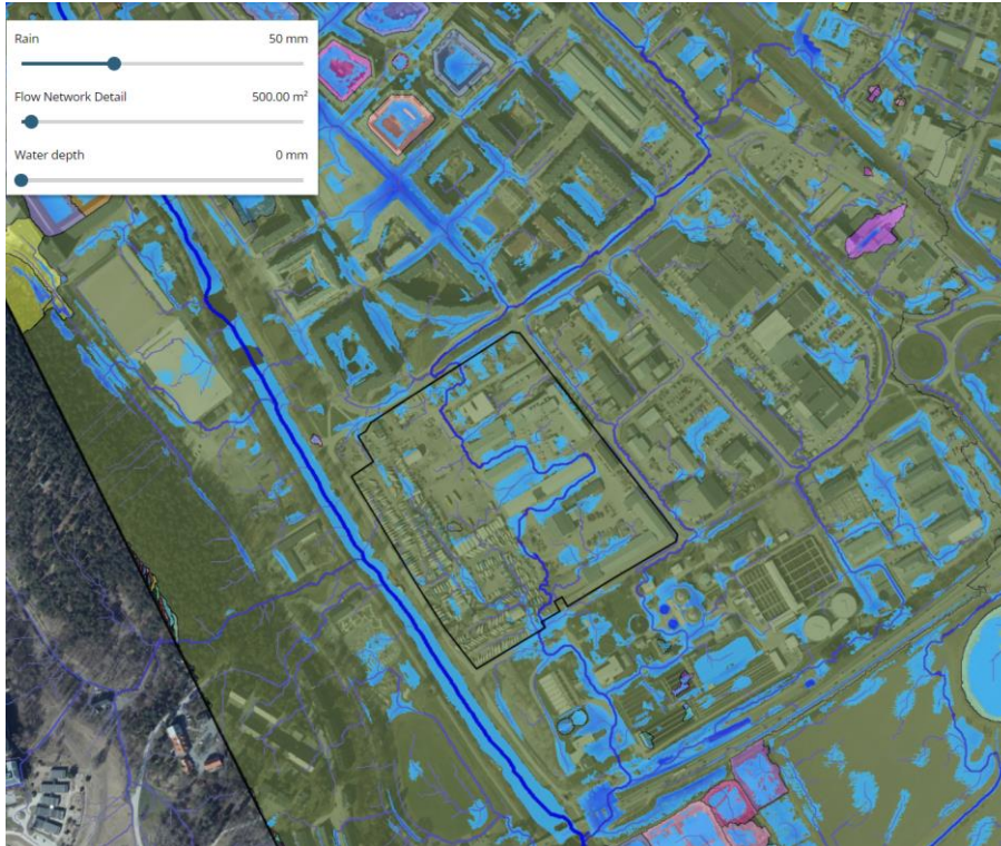
Figur 8. Översvämningssituation för planområdet vid 50 mm nederbörd. Avrinningsområden, avrinningsstråk och lågpunkter är taget från SCALGO Live.
