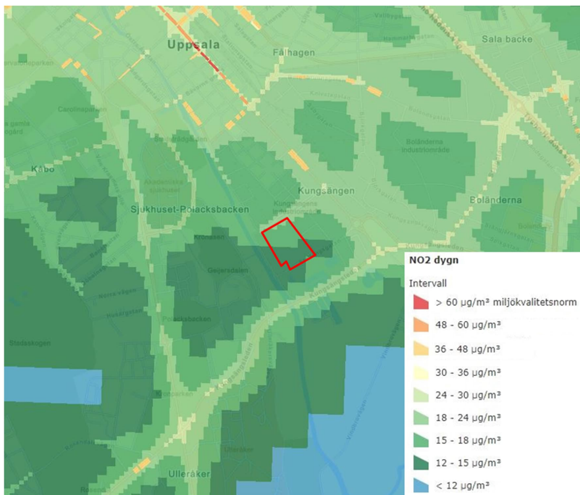
Figur 7. Översiktligt beräknade halter av dygnsvärden för NO 2 år 2020. Kvarteret Kölen är markerad på kartan. Inom kvarteret återfinns halter i intervallet 12 - 24 µg/m 3 , MKN är 60 µg/m 3 .
