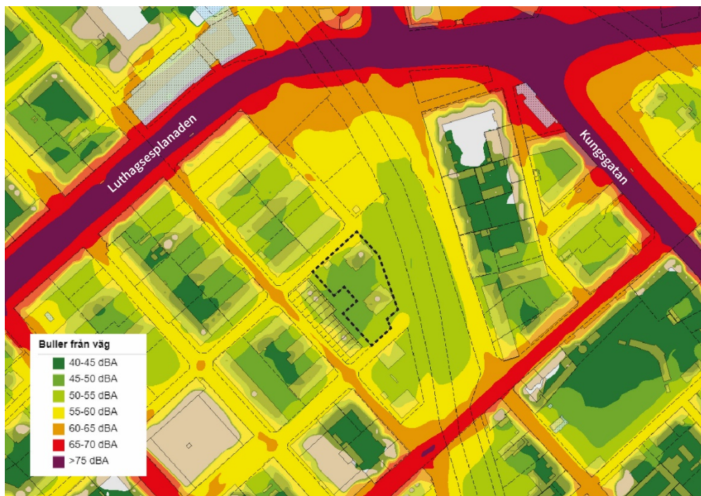
Bild 18. Utdrag ur kommunens bullerkartläggning som visar att punkthusens fasader ligger inom spannet 45 till 55 dBA, samt att ena hörnet på den norra byggnaden har 55 till 60 dBA vid fasad. Planområdet är markerat med en streckad linje.
