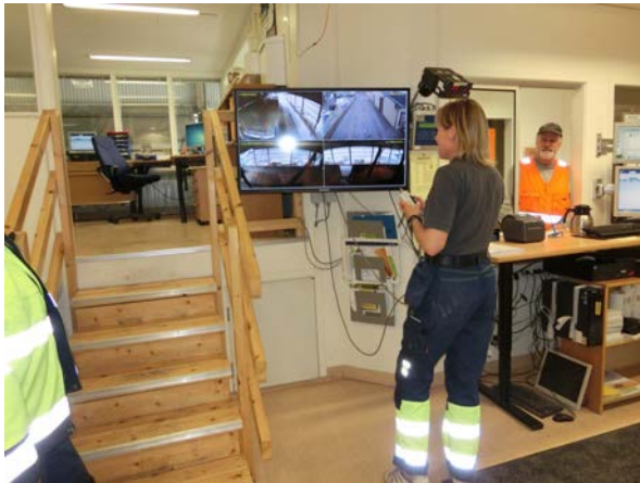
Mottagning och prövtagning av lasten i laboratoriebyggnaden sköts via bildskärmar och datorstyrning.
