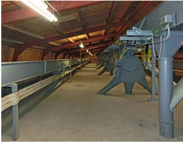
Ovan: Lanterninen på silo 3 med transportör och fördelare mellan de olika lagringsfickorna.
