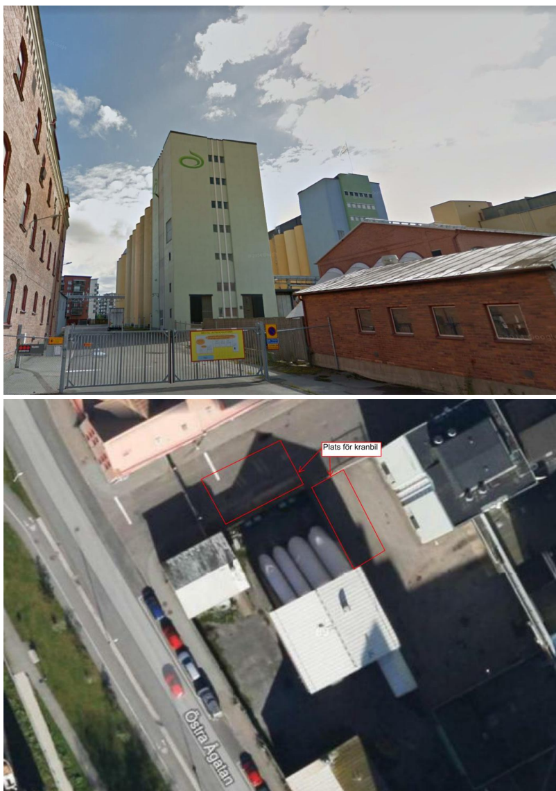
Bild 6. Uppställningsplatser för kranbil för lyft av lock till pumpsump.
