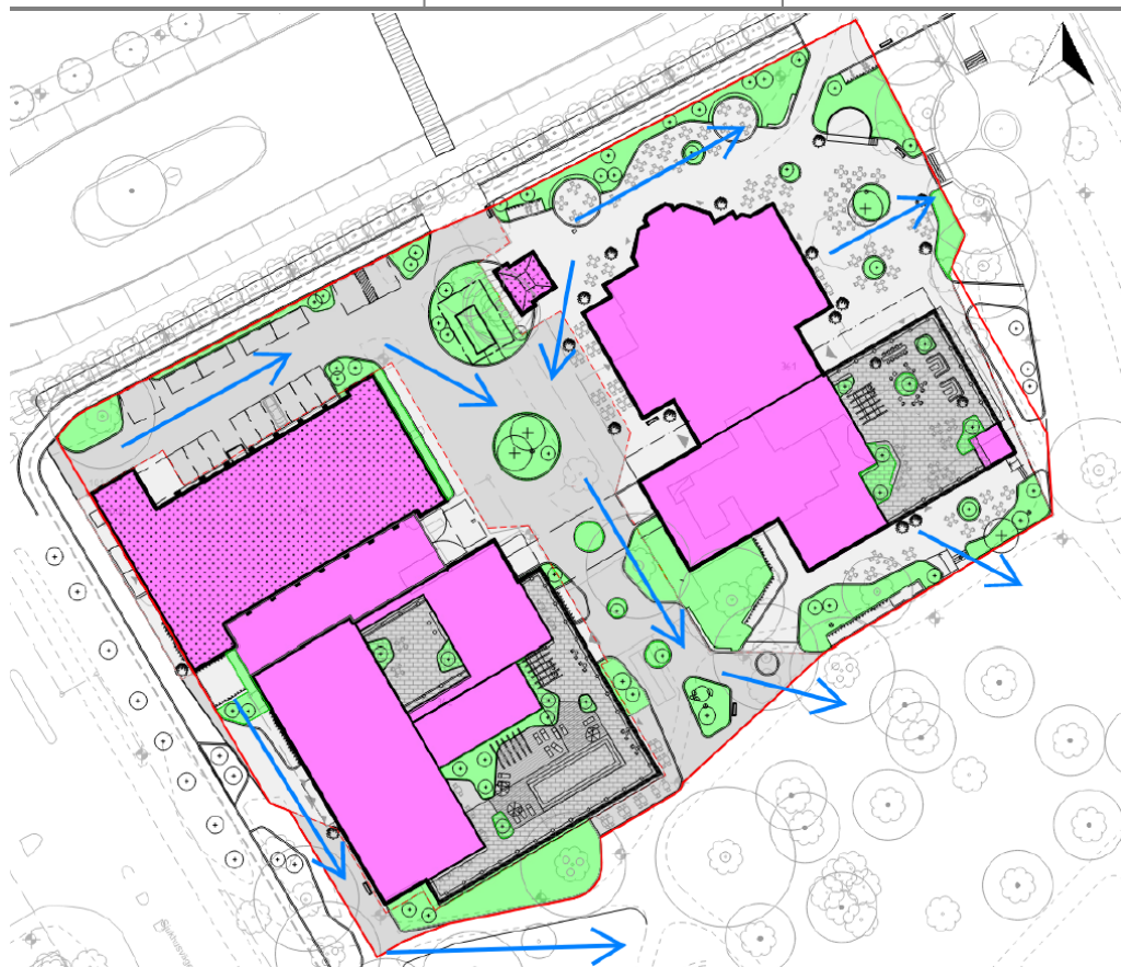
Figur 43 - Föreslagna skyfallsvägar inom utredningsområdet, Structor.
