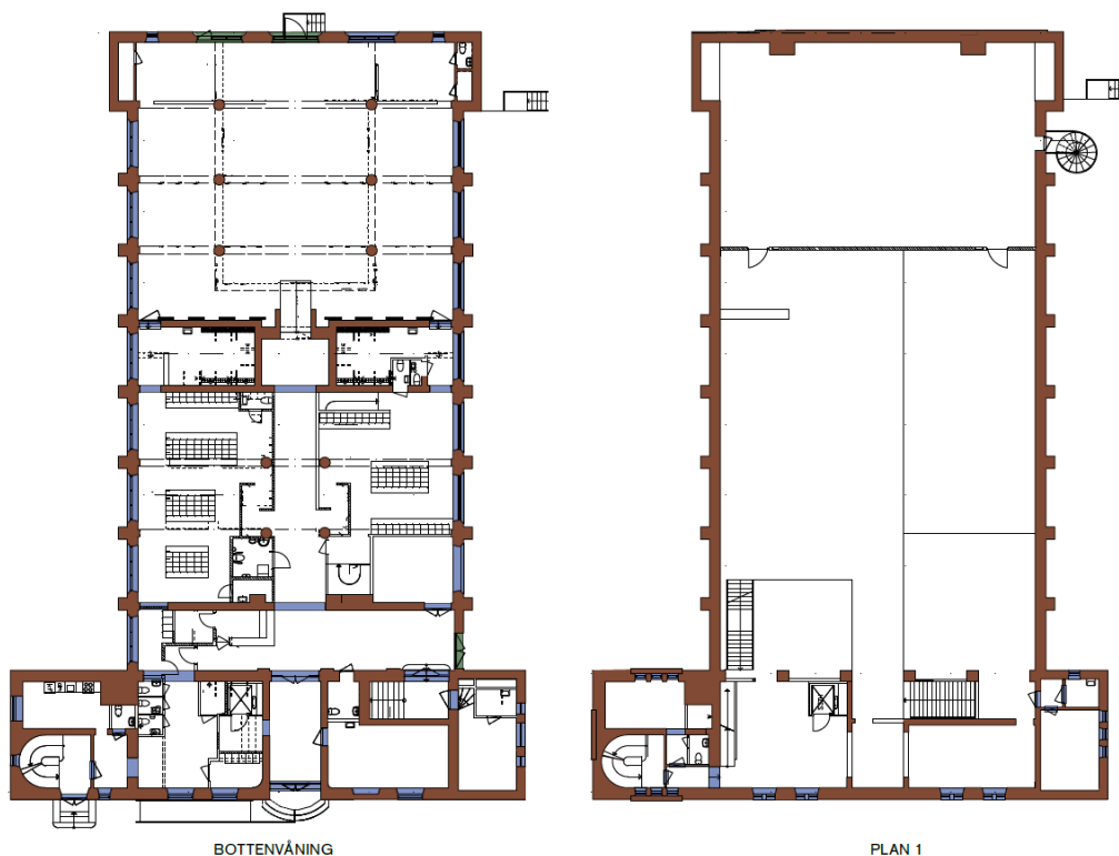
Figur 34- Illustrationer visar de ursprungliga vägg- och murytor som finns kvar än idag. Även befintliga kvarvarande öppningar redovisas, så som fönster och portar, ursprungliga
