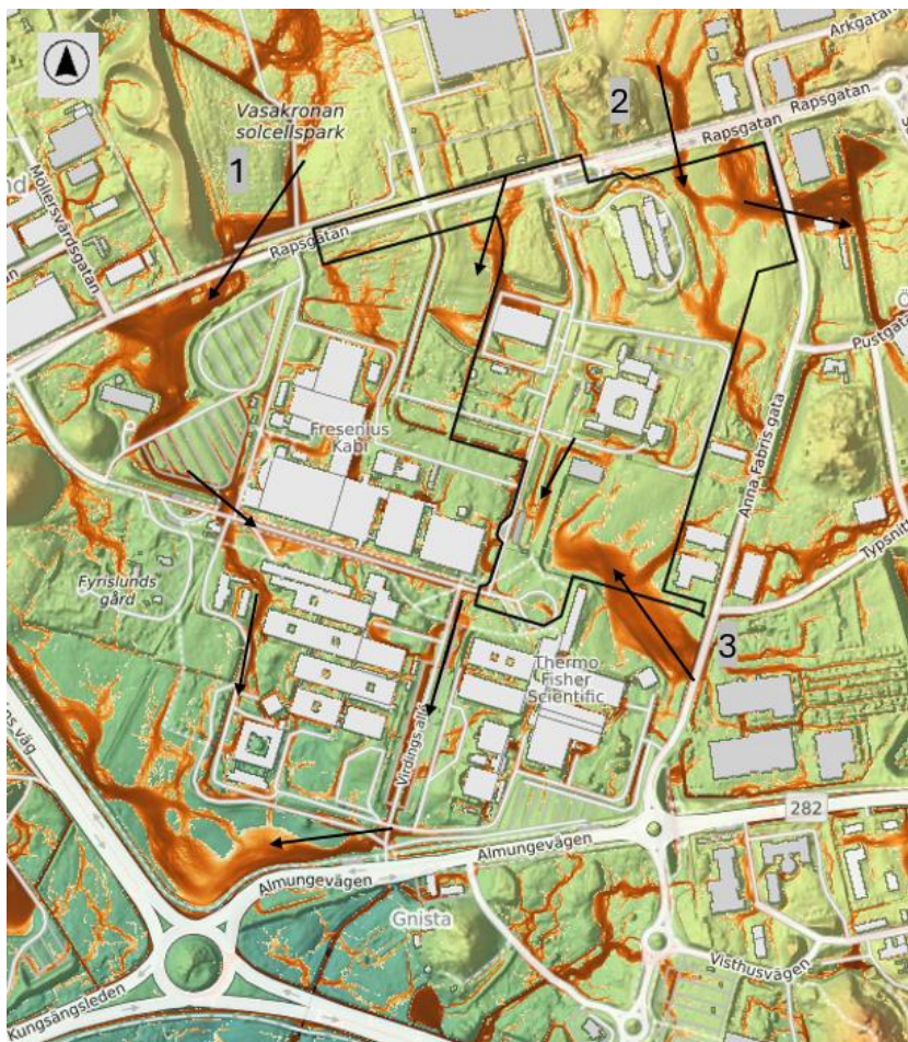
Figur 2: Flödesvägar för befintligt scenario vid 100-årsregn.
