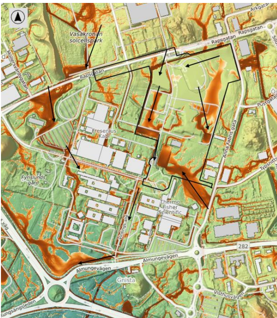
Figur 6: Flödesvägar för framtida scenario med skyfallsytor och dikesstråk runt området, vid ett 100-årsregn.
