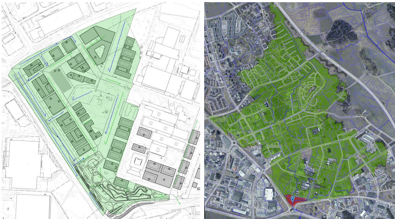
Figur 7. Till vänster: Tekniskt avrinningsområde till Södra dammparken. Reducerad area är ca 12,5 ha. Till höger: Avrinningsområde för ytlig avrinning vid extrema regn. Figur hämtad från Scalgo Live (2023-11-23) med nederbördsmängd 100 mm.
