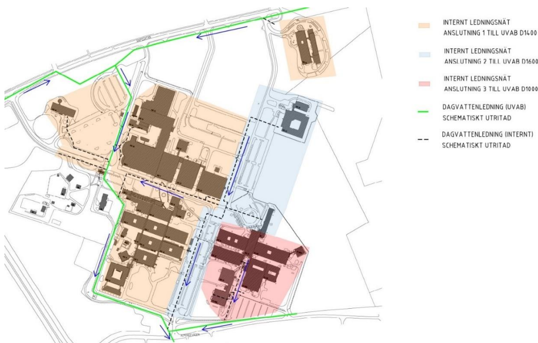
Figur 4. Befintligt dagvattensystem inom utredningsområdet. Indelningen av tekniska områden är uppskattad utifrån tillgängligt ledningsunderlag.
