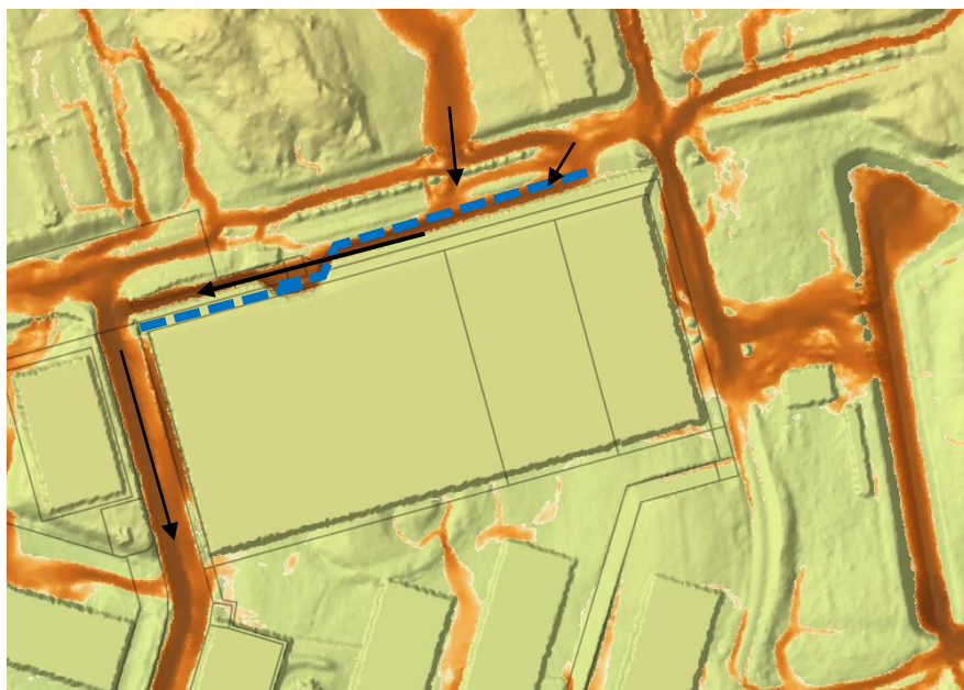
Figur 19. Skyfallsmodellering framtida situation. I modelleringen ingår ett projekterat skyfallsdike som leder om avrinningen till gata 5. I denna simulering är byggrätten maximerad med en byggnad för att illustrera detta scenario. I en senare version av dikesprojekteringen är placeringen ändrad enligt streckad blå linje. Plangränserna i figuren är utkast från 2023-12-20. Plangränserna till slutgiltig plankarta ska anpassas för att ge plats åt skyfallsdiket.
