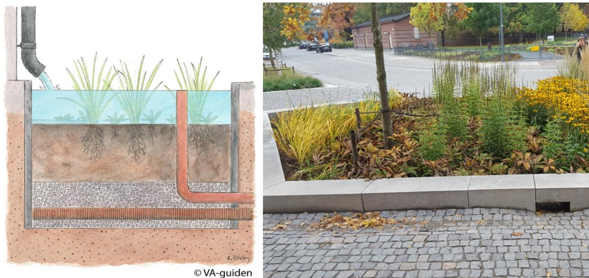
Figur 9. T.v. principskiss (källa: VA-guiden, u.å.) och t.h. exempelbild av nedsänkta växtbäddar.
