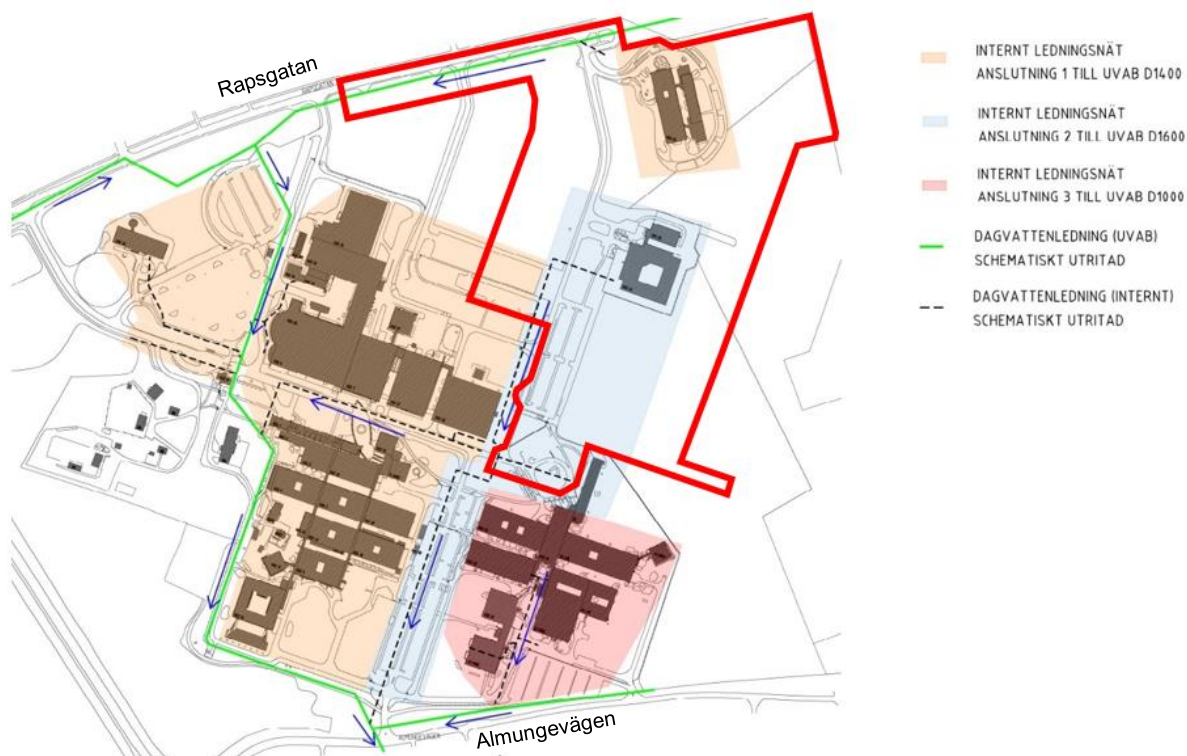
Figur 3. Tekniska avrinningsområden och befintliga dagvattenledningar. Plangräns för etapp 1 i röd linje.
