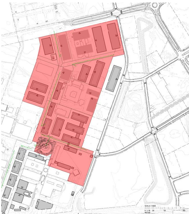
Figur 14. Tillrinningsområdet som användes för dimensionering visas i rött, reducerad area är 13,9 ha.
