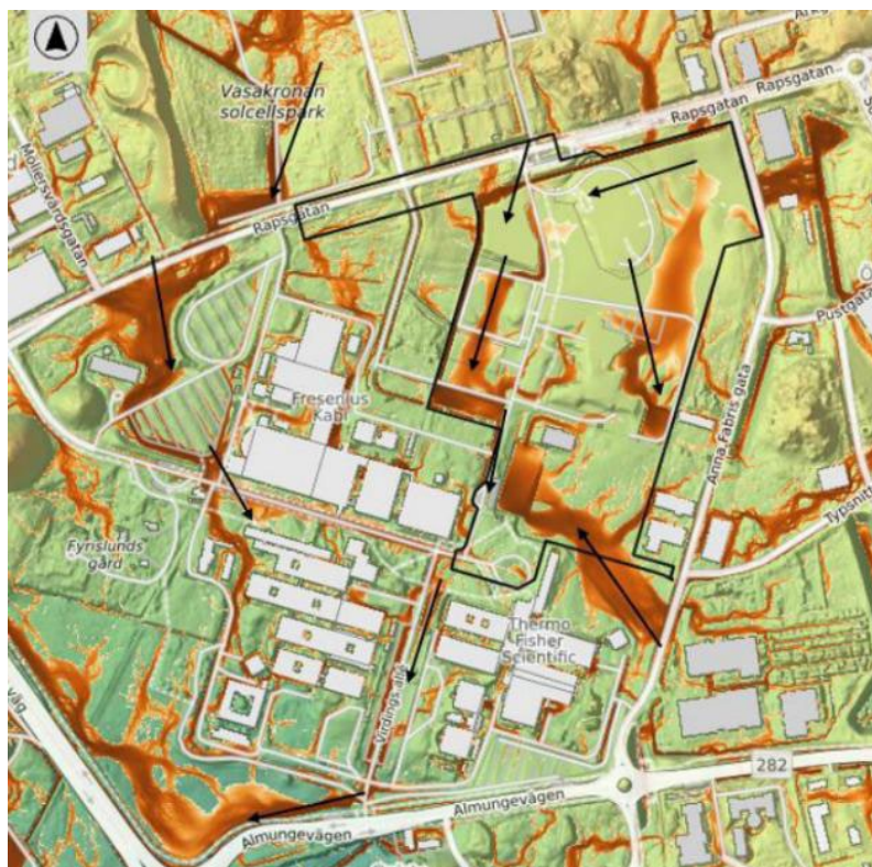
Bild 55 Flödesvägar efter detaljplanens genomförande, med skyfallsytor och dikesstråk, vid ett 100-årsregn.
