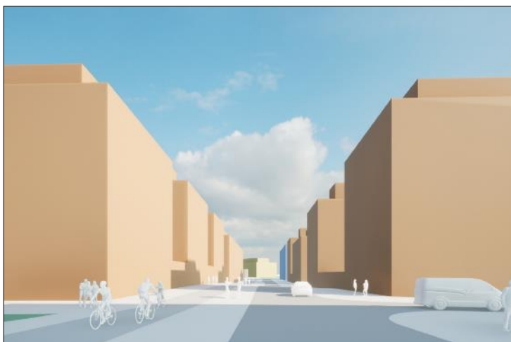
Bild 43. Volymbild över bebyggelsen vid den nya lokalgatan i Fyrislundsgatans förlängning. Bebyggelsen till höger på bilden ska utformas med indrag, släpp eller en variation i våningsantalet. Bild Mandaworks.
