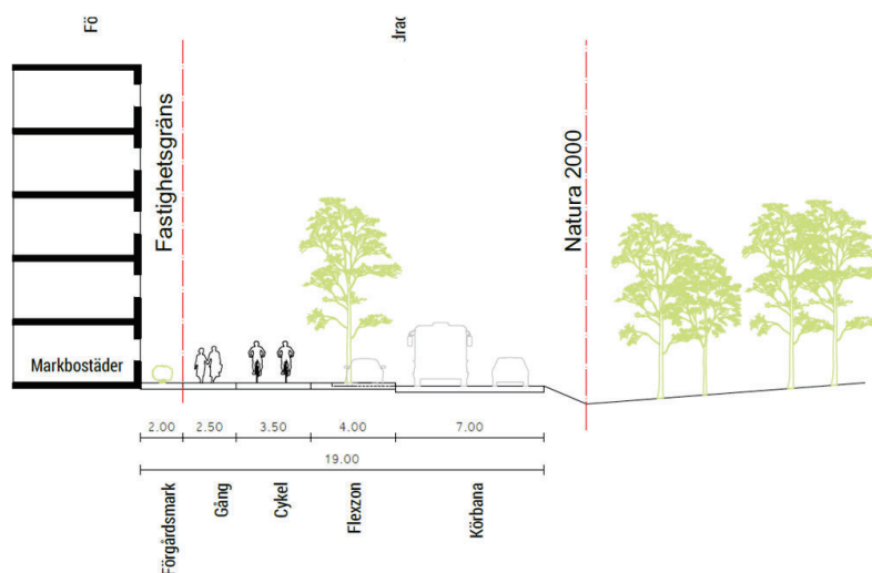
Figur 17. Sektion Elfrida Andrées väg, nybyggd sträcka. Illustration Mandaworks och Warm in the Winter.
