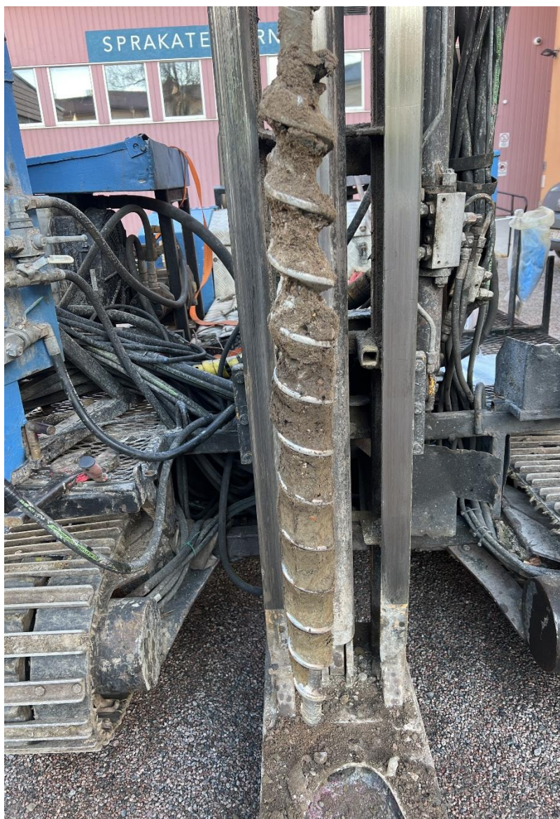
Bild 3: Provpunkt 24DM03, 0-1 m. Fyllnadsmassor från 0-1 m, sedan lera till önskat borrhjup om 4 m.
