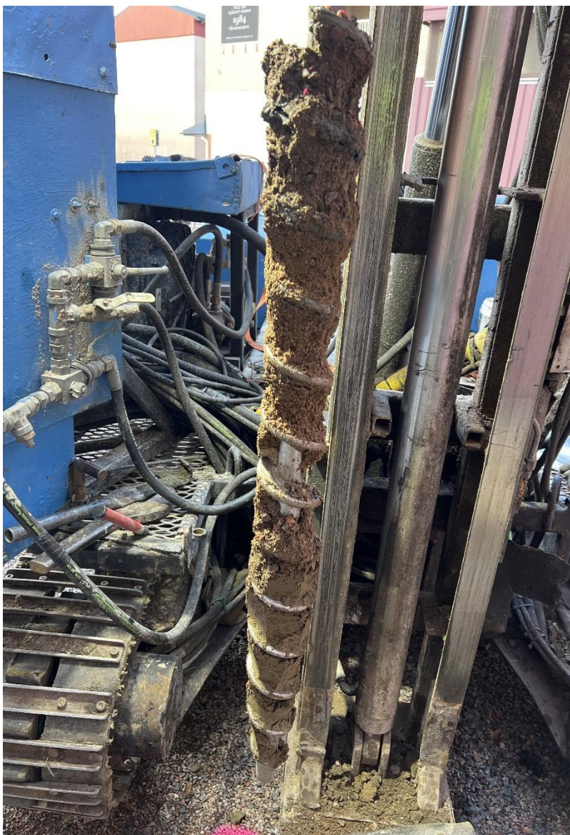
Bild 3: Provpunkt 24DM05, 0-1 m. Fyllnadsmassor av mestadels sand från 0-1, sedan lera till önskat borrhjup om 4 m.
