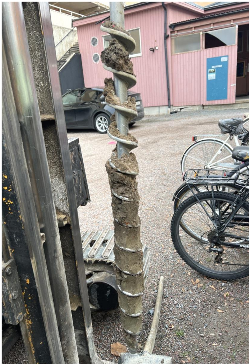
Bild 1: Provpunkt 24DM01, 0-1 m. Fyllnadsmassor övre 0,5 m, sedan lera till önskat borrhjup om 4 m.
