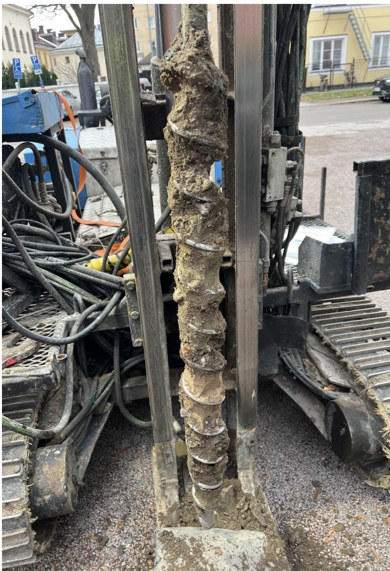
Bild 3: Provpunkt 24DM02, 0-1 m. Fyllnadsmassor från 0-1 m, sedan lera till önskat borrhjup om 4 m.
