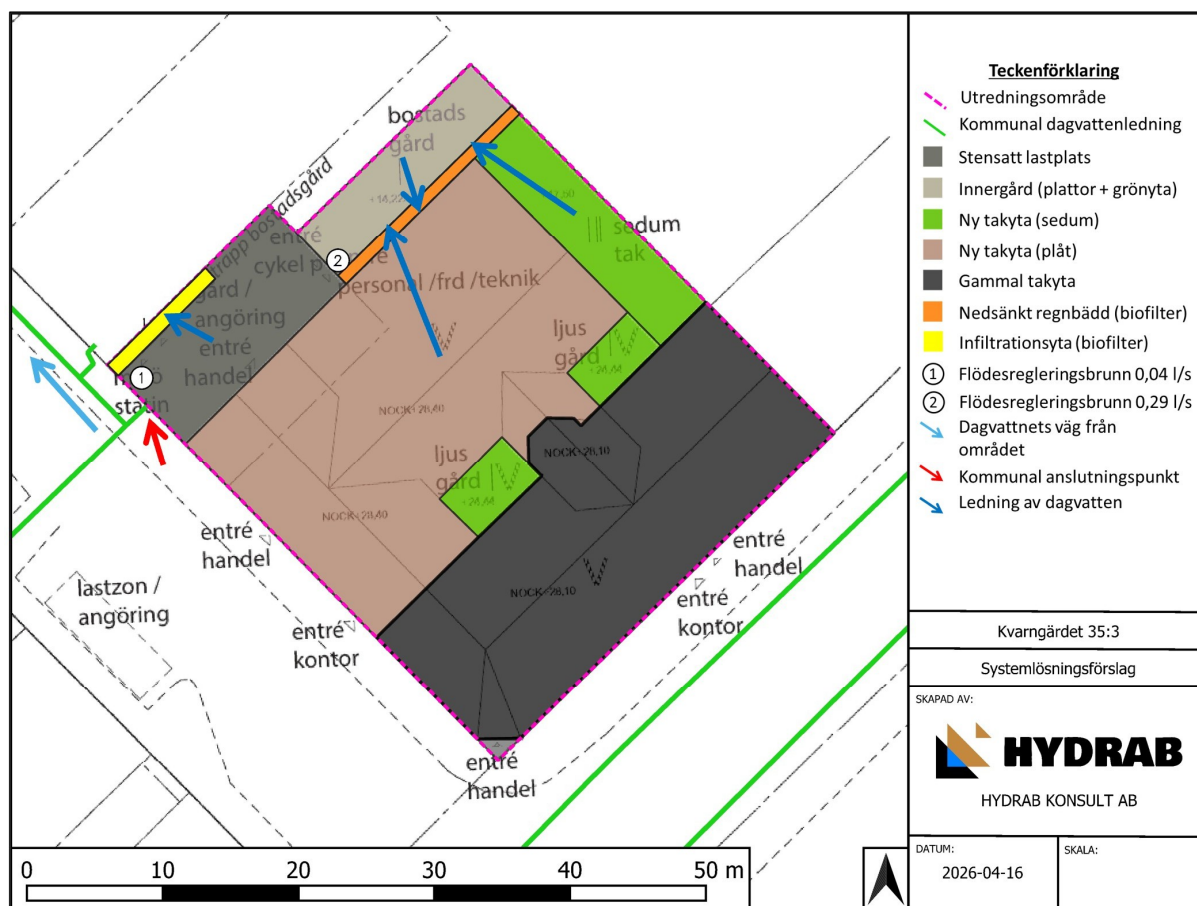
Figur 13. Planerad bebyggelse enligt situationsplan med systemlösningsförslag för bortledning av dagvatten.
