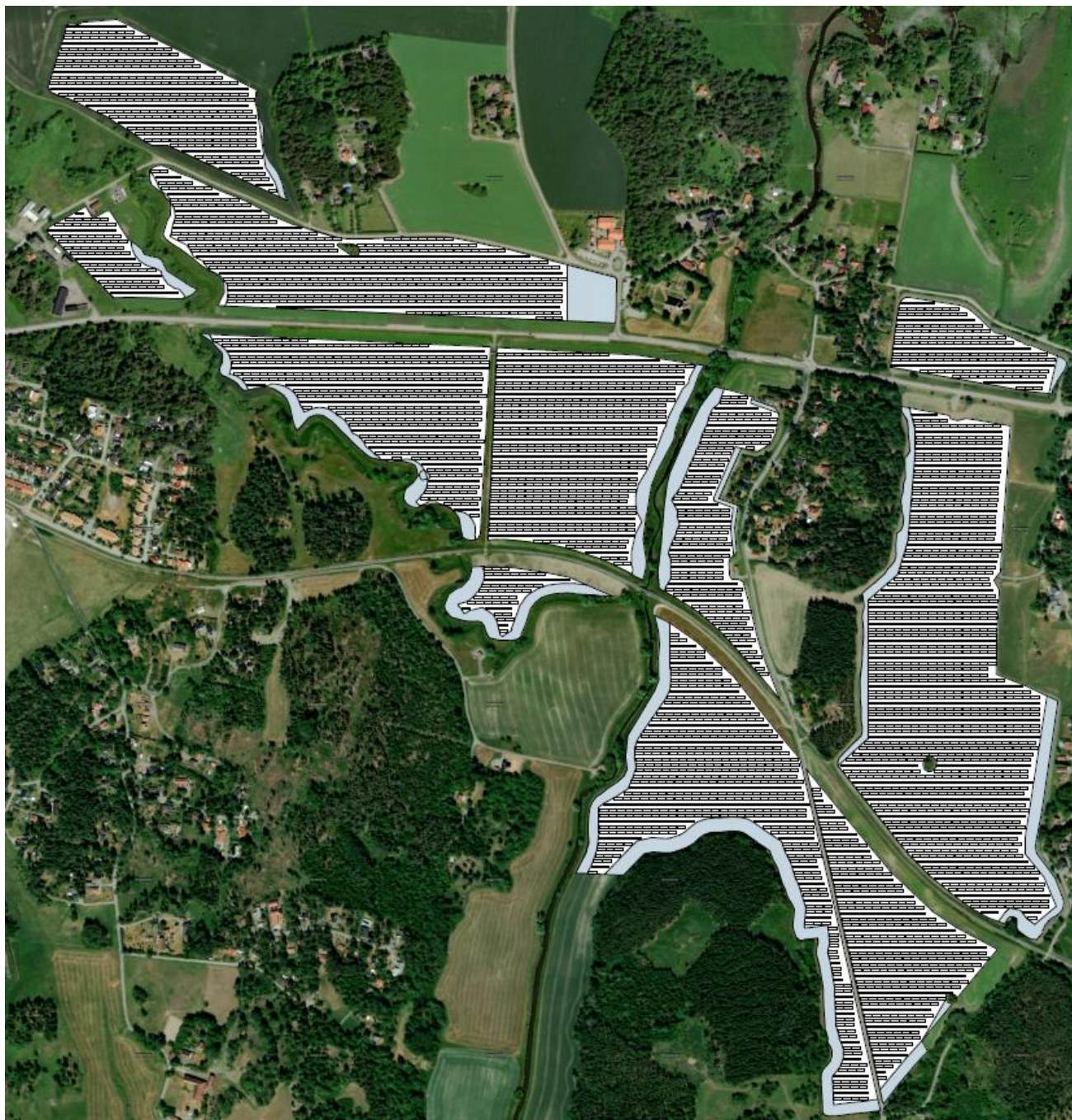
Figur 5-Planvy: exempel på solcellsparkens layout med gråa zoner som visar projektområdet och svarta rader som visar solcellspaneler.
