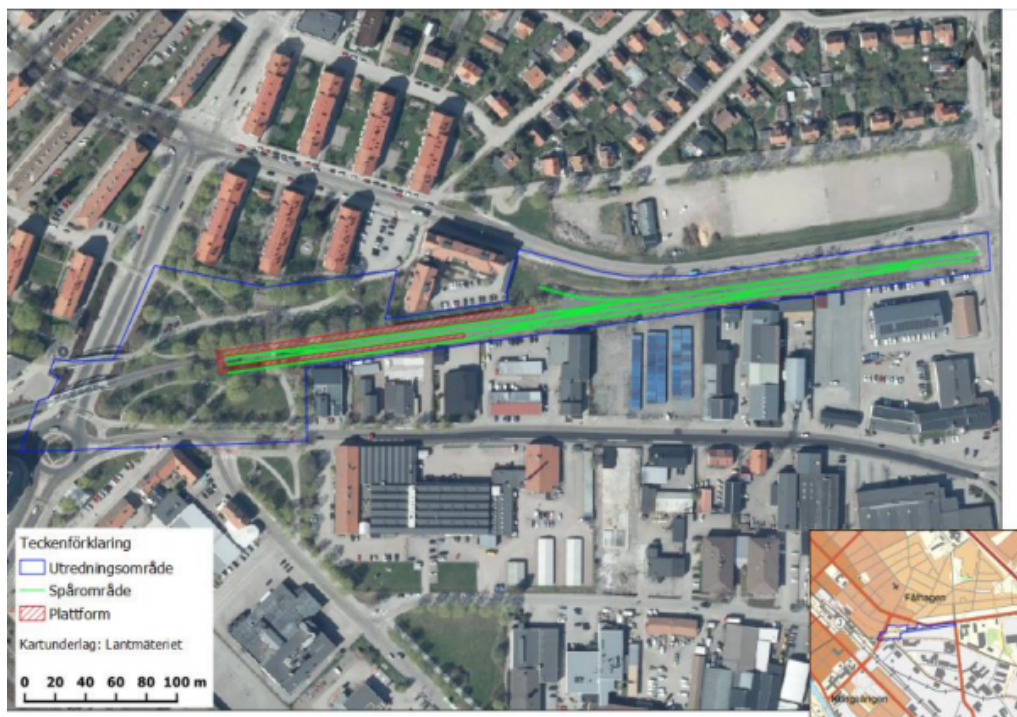
Figur 3. Planerat spårområdet och föreslagen plattformslösning i förhållande till järnvägsplanens utredningsområde (Rejlers)
