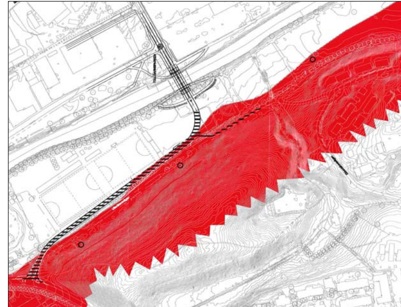
Ulleråkersvägen befintliga förutsättningar. Röd färg: lerdjupet är mindre än 10 m, brunnar markerade med cirklar (Ramböll)
