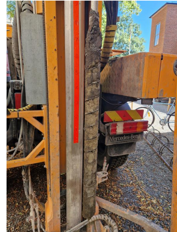
Exempel på skruvprov av fyllning (t.v.), samt underliggande lera (t.h.)
