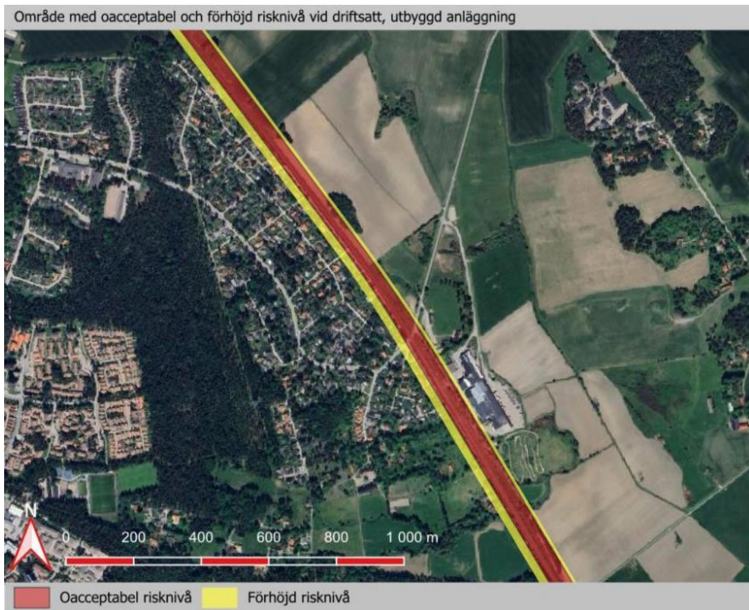
Figur 6. Område i Bergsbrunna med oacceptabel och förhöjd risknivå vid driftsatt, utbyggd anläggning. Se bilaga G för mer en mer detaljerad karta.
