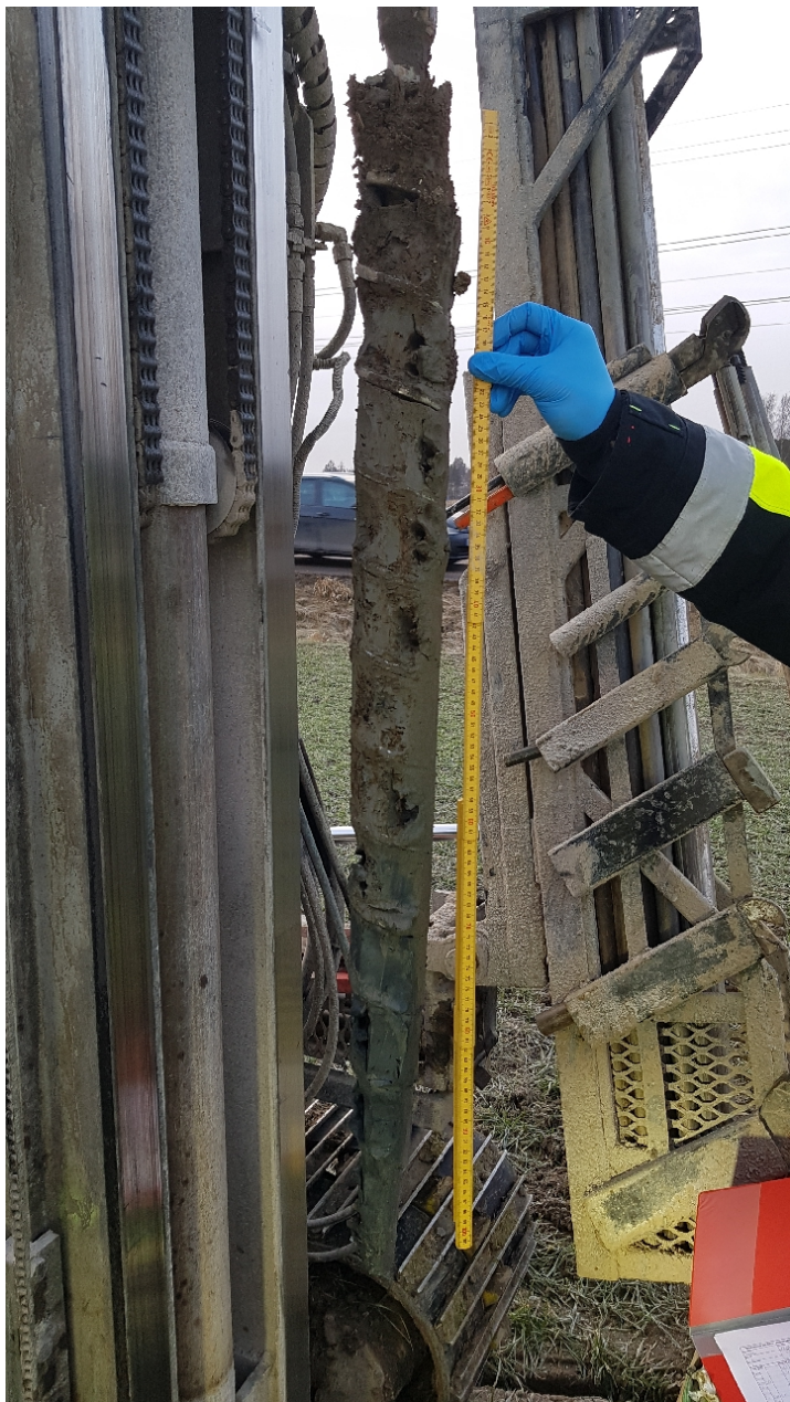
Figur 29. Skrivborrning och pH-mätning vid punkt 22S093. Djupintervallen som visas är 1,00-2,00 meter under markyta.
