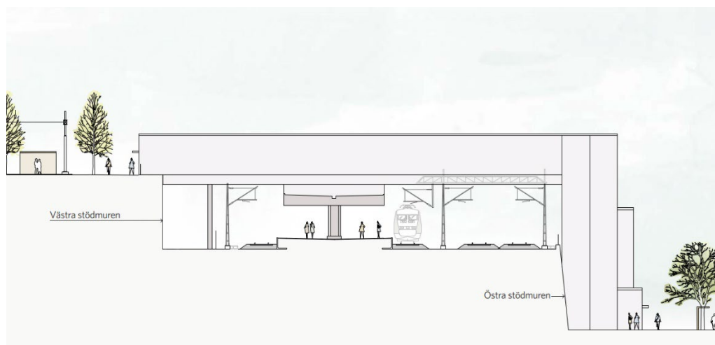
Figur 9: Illustration som visar hur stationen är placerad utifrån tänkta marknivåer. Bild: Sweco, redigerad av Uppsala kommun. På västra sidan, till vänster i bild, kommer marknivån att vara +35 meter och på östra sidan, till höger i bild, kommer marknivån att vara +16,5 meter. Det innebär att den totala nivåskillnaden som stationen ska hantera är 18,5 m mellan de båda sidorna om stationen. Spåren ligger på en höjd om +25,5 meter.
