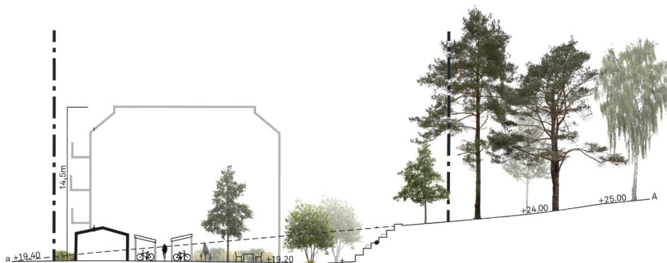
Figur 8 Sektion för punkthusen som visar hur byggnaderna möter huvudgatan, samt skogskullen öster om husen. Bilden är framtagen av Ettelva arkitekter.
