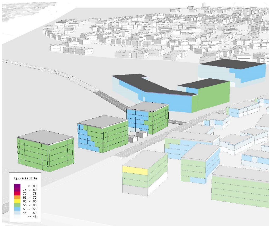
Figur 18 Punkthusen och skolan på vänstra sidan om huvudgatan. Blå och grönmarkerade sidor är under riktvärdena för buller. Nedtonade delar i bilden hör till kommande etapputbyggnad.
