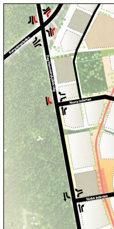
Figur 9. Korsningar med de svängrörelser som är högst belastade (röda pilar).
