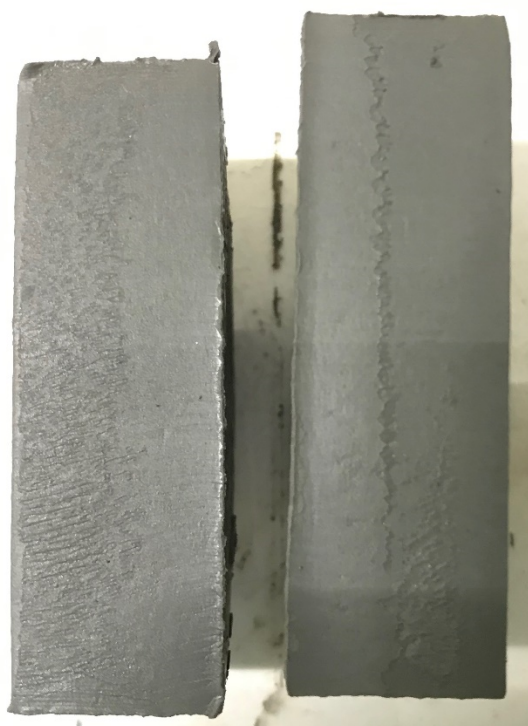
Figur 4 Borrpunkten, BG19011F, 12,0 m, Jordprovet i övre delen av mellanhylsan delad longitudinellt provhylsan med id Bjerking204.
