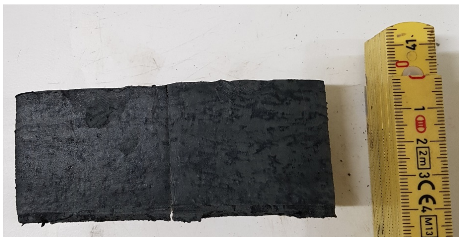
Figur 7 Borrpunkten, BG19003, 6,5 m, Jordprovet i övre delen av mellanhylsan delad longitudinellt provhylsan med id Bjerking377
