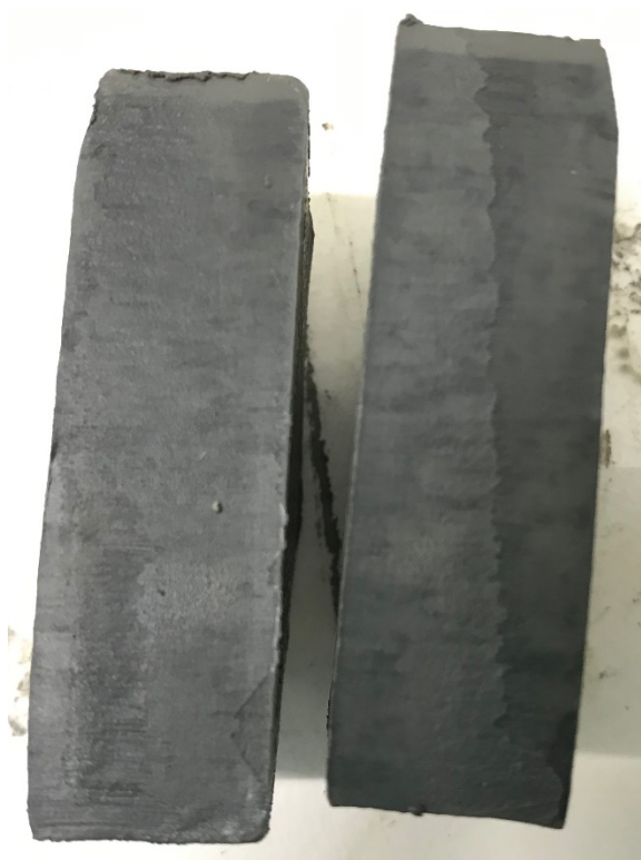
Figur 3 Borrpunkten, BG19011F, 9,0 m, Jordprovet i övre delen av mellanhylsan delad longitudinellt provhylsan med id Bjerking255
