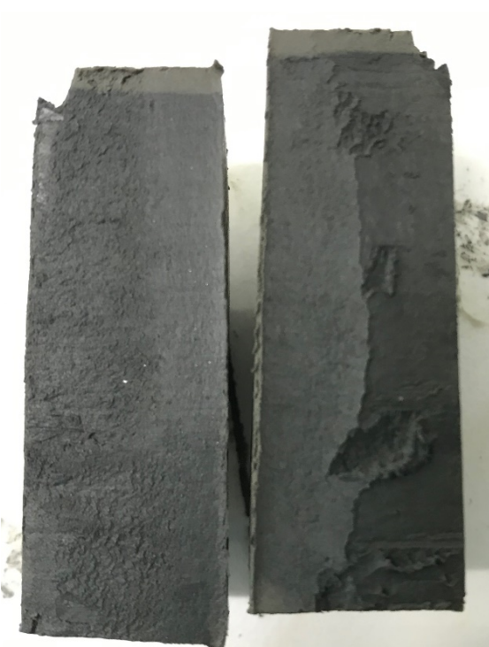
Figur 2 Borrpunkten, BG19011F, 5,0 m, Jordprovet i övre delen av mellanhylsan delad longitudinellt provhylsan med id Bjerking225
