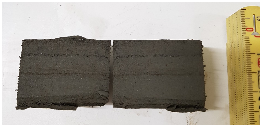
Figur 6 Borrpunkten, BG19003, 4,5 m, Jordprovet i övre delen av mellanhylsan delad longitudinellt provhylsan med id Bjerking381
