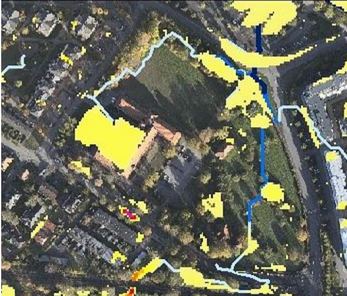
Figur 4-5. Flödesvägar och instängda områden för det aktuella utredningsområdet. Analys av flödesvägar och instängda lågpunkter utförd av Uppsala Vatten AB och WSP (datum saknas).
