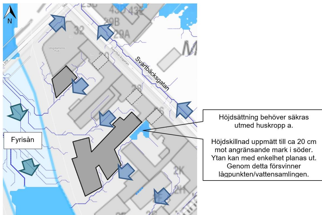
Figur 12. Rinnvägar enligt nuvarande höjdsättning tillsammans med inlagda ytor för planerad byggnation. Portiker mot Svartbäcksgatan är markerat som streckade boxar.
