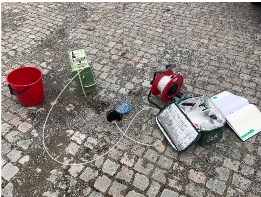
Figur 5: Foto över provtagning med peristaltisk pump
