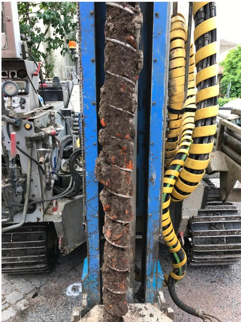
Figur 3: Foto över hur markprofilen såg ut från 1,0 - 2,0 meter vid provpunkt C6. På skruven observeras röda fraktioner av tegel.
