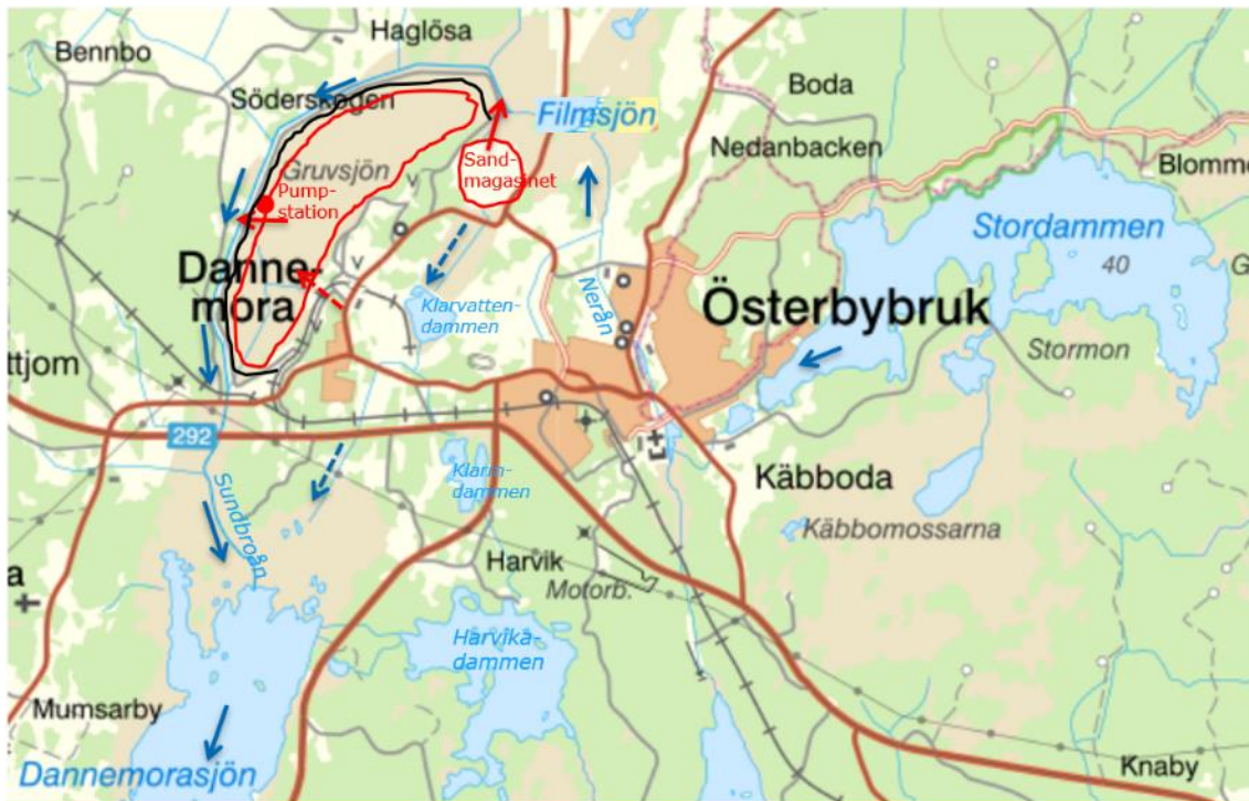
Figur 31. Karta över Dannemoras omgivning med lägen för sandmagasinet, Gruvsjön och pumpstationen i Gruvsjön, samtliga markerade med rött, liksom pilar för vattenvägar (blå) och för förorenade utsläpp (röda).
