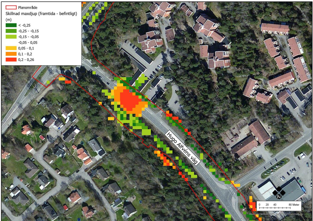
Figur 5:19. Skilnad i maximalt vattendjup mellan framtida och befintlig situation vid studerat 100-årsregn med klimatkfaktor 1.3. Planområdet är preliminärt.
