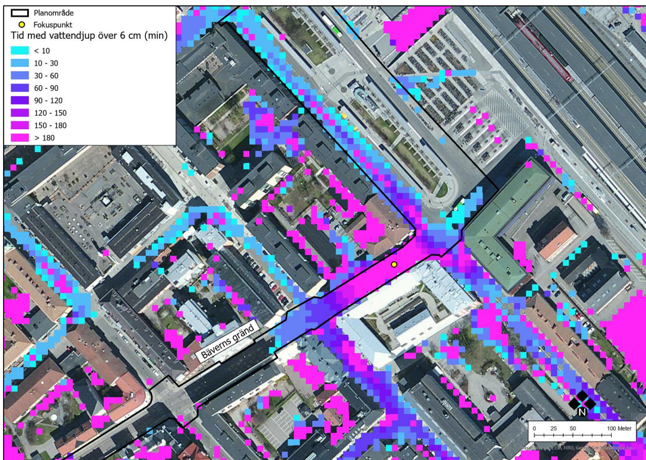
Figur 5:26. Tid då det beräknas stå vatten med ett vattendjup på minst 6 cm vid studerat 100-årsregn. Fokuspunkten är belägen i Bäverns gränd. Planområdet är preliminärt.
