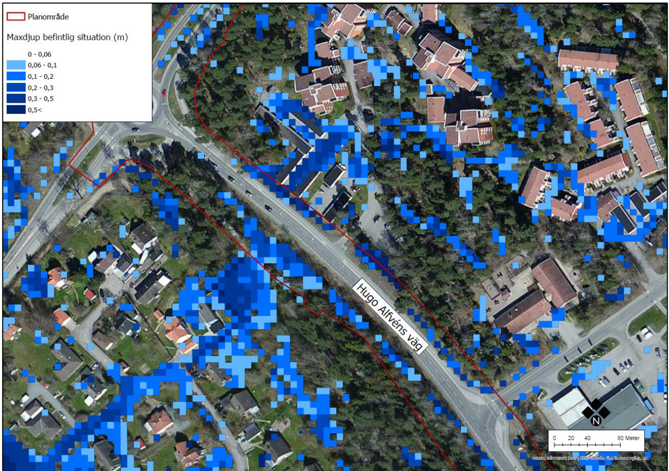
Figur 5:6. Beräknade maximala vattendjup vid befintlig situation och ett 100-årsregn inklusive klimatfaktor 1,3. Planområdet är preliminärt.
