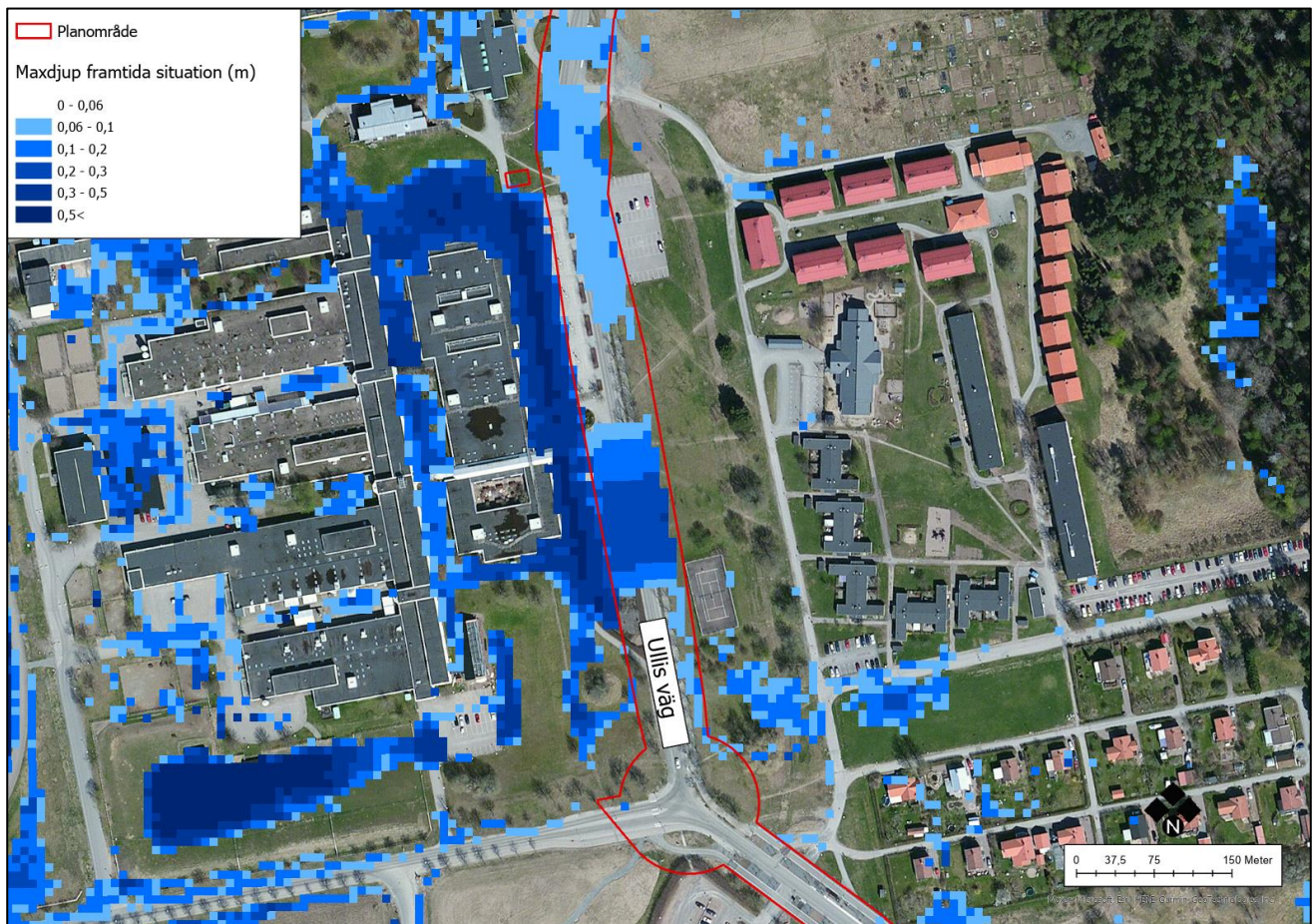
Figur 5:24. Beräknade maximala vattendjup vid planerad situation i samband med ett 100-årsregn inklusive klimatfaktor 1,3. Planområdet är preliminärt.
