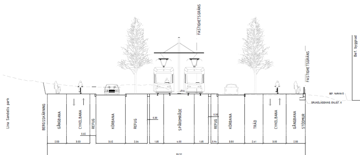
Figur 29 Sektion B32 mellan Bandstolsvägen och Stenhammars väg där det krävs bergsskärning på västra sidan.
