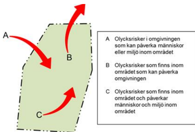
Figur 3-3: En illustration av tre olika perspektiv vid identifikation av olycksrisker. Figur efter MSB [11].
