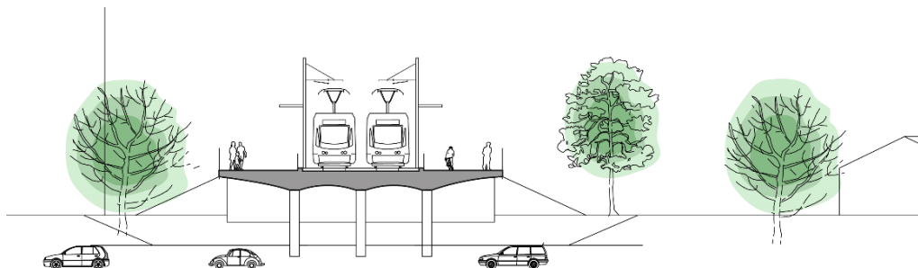
Bild 29 Sektion på bron över Kungsängsleden. Bron konstrueras för att möjliggöra eventuell framtida breddning av Kungsängsleden från två till fyra körfält (Ramboll. Bearbetad av stadsbyggnadsförvaltningen).
