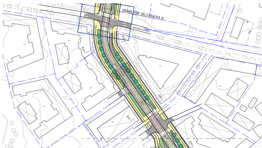
Bild 23 Illustrationsplan från förprojekteringen söder om korsningen Torgny Segerstedt allé/Rosendalsvägen där kollektivtrafik och motorfordon delar körfält i södergående riktning (Systra/White arkitekter).
