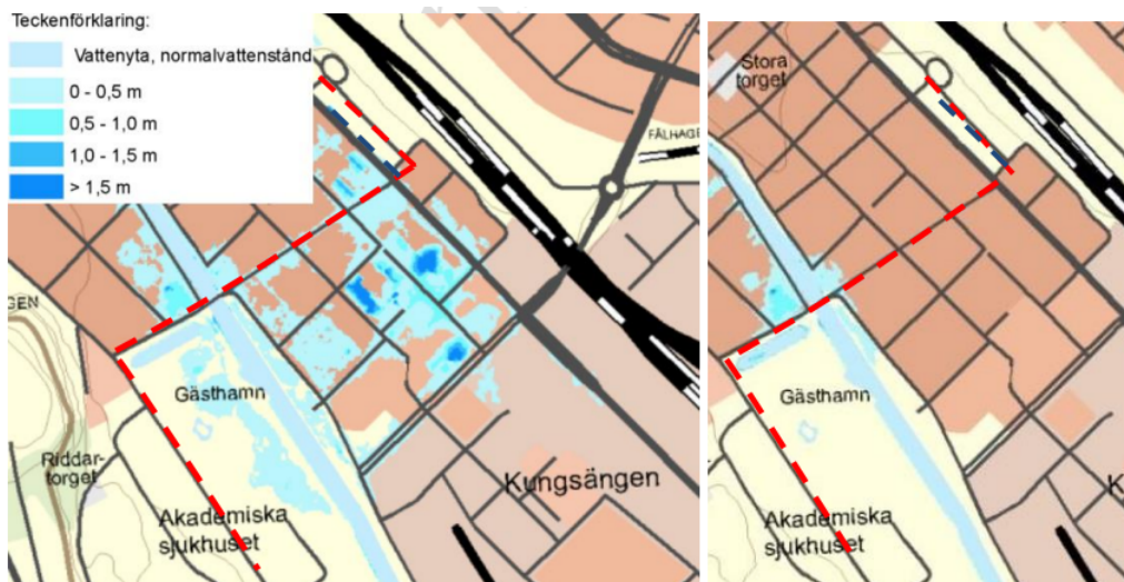
Bild 43 Detaljerad översvämningskartering i centrala Uppsala med vattendjup vid ett 100-årsflöde till vänster och ett 50-årsflöde till höger. Kollektivtrafikstråket är markerat med röd streckad linje. Vid ett 50-årsflöde är det endast området kring Islandsbron. Översiktlig vattenutredning, WSP.
