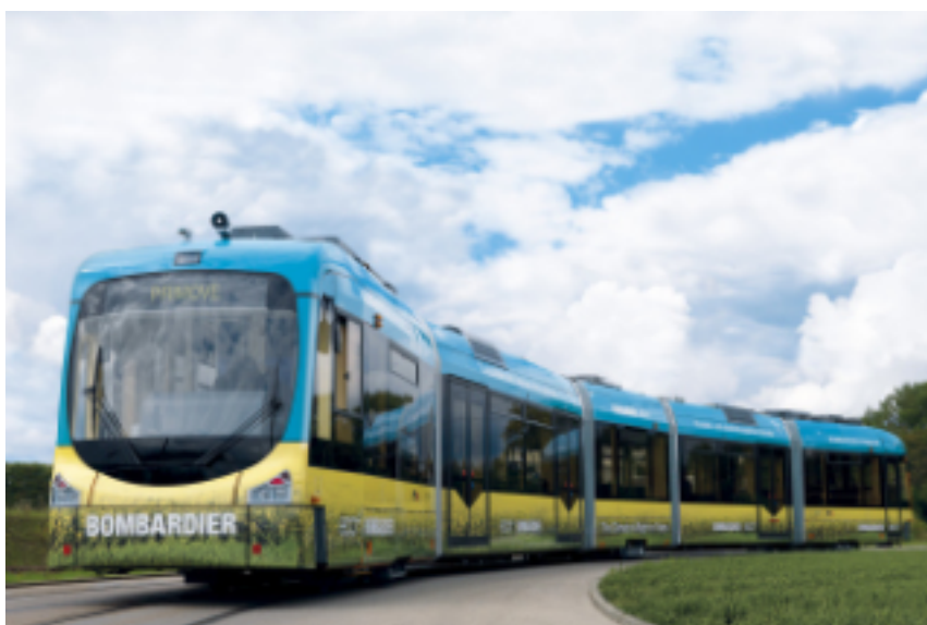
Figur 6.1 Bombardier Primove batterispårvagn som laddas induktivt i Nanjing, Kina.
