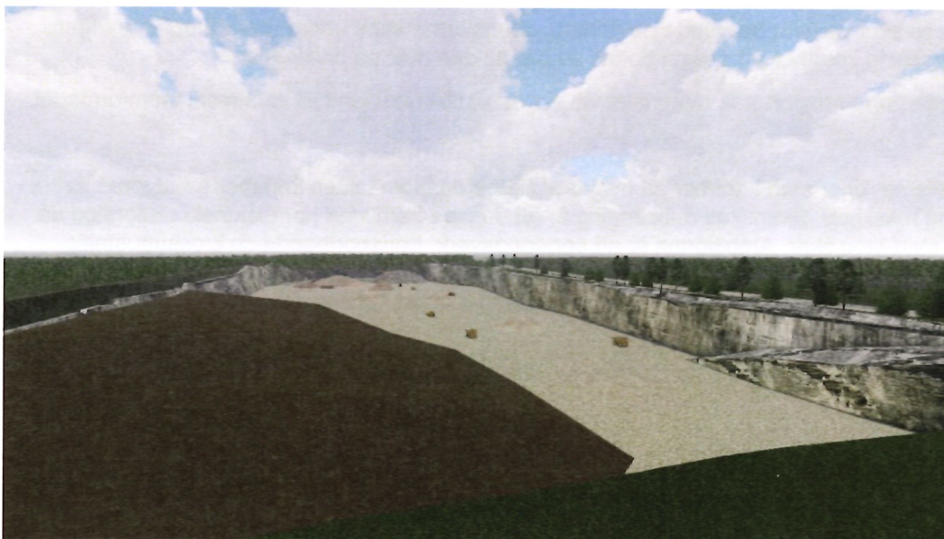
Figur 3. Illustration över området under etapp 2. Området till vänster i illustrationen är delvis återfyllt med inerta schaktmassor, dvs. i områdets södra del. Bilden visar området från söder mot norr med ramp i öster och bullervall i väster.
