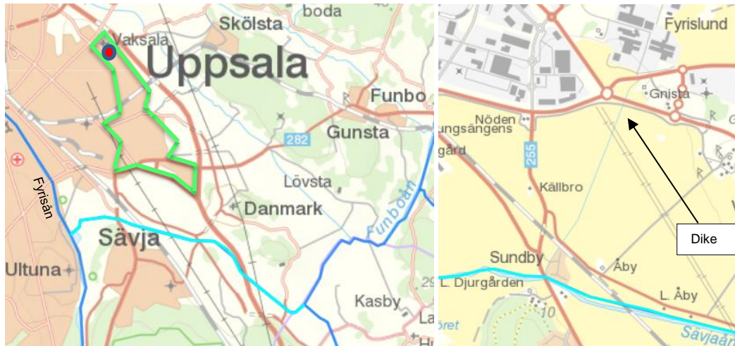
Figur 6. T.v. Sävjaåns utlopp väster ut i Fyrissan med avrinningsområde för dagvatten till Sävjaån markerat i grönt och planområdet med röd prick. T.h. dike mellan Gnista och Sävjaån där dagvattenledning mynnar i diket. Karta: VISS.
